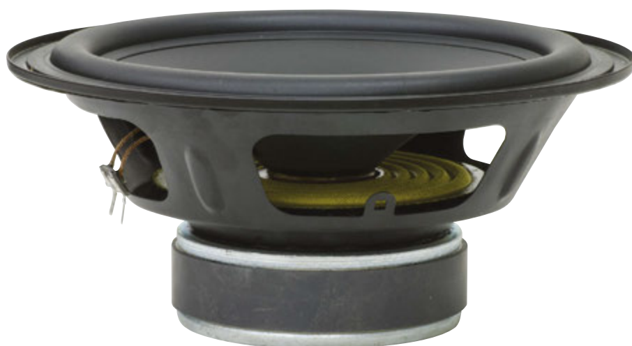
Uno dei due woofer della Dhavani. Notare la sospensione in gomma e la membrana in cellulosa trattata soltanto sulla faccia a vista. Il cestello è in lamiera stampata ed il complesso magnetico di dimensioni non strabilianti.
