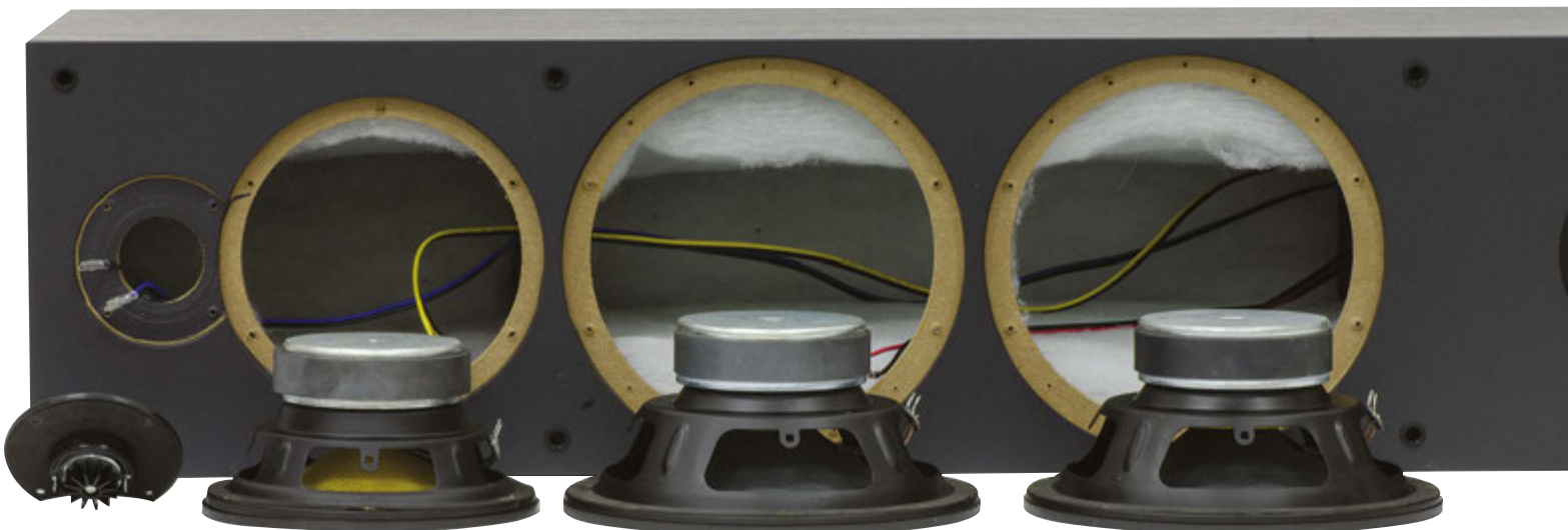
Il diffusore smontato. Notiamo il midrange in fibra di vetro, con il suo subvolume, ed i due woofer montati in parallelo nel grande volume coibentato.
